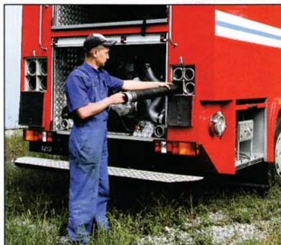
На ПНРС-110 тяжелые всасывающие рукава (ок. 60 кг) расположены так, что их легко доставать и загружать обратно.
