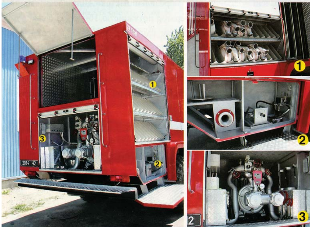
1 – отсек для пожарных рукавов; 2 – устройство механизированной размотки рукавов; 3 – центробежный насос производительностью 100 л/сек.
